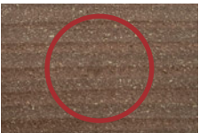
natürlicher Fasereinschluss nach mechanischer Behandlung
